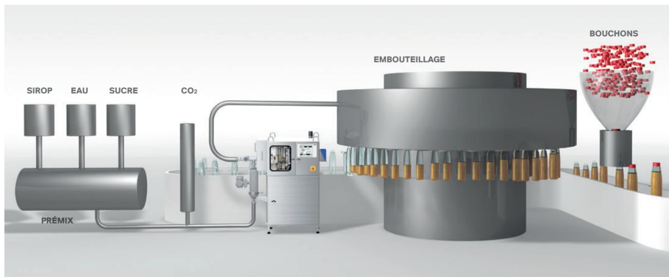
La pompe de dosage Velcorin est intégrée aux chaînes d'embouteillage nouvelles ou existantes. Les modifications à apporter à une chaîne d'embouteillage déjà existante sont minimales.
