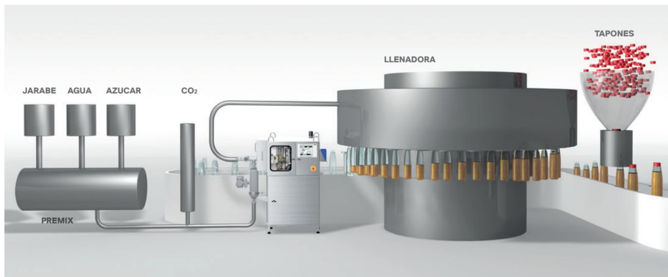
La unidad de dosificación Velcorin® se instala en líneas de llenado nuevas o ya existentes. Sólo se requieren modificaciones menores de la línea de llenado para este propósito.
