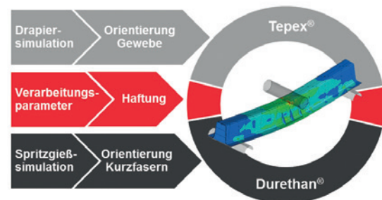
Bild 29: Das Bild zeigt die wichtigsten Einflussfaktoren auf die integrative Simulation von Tepex®-Hybridbauteilen
