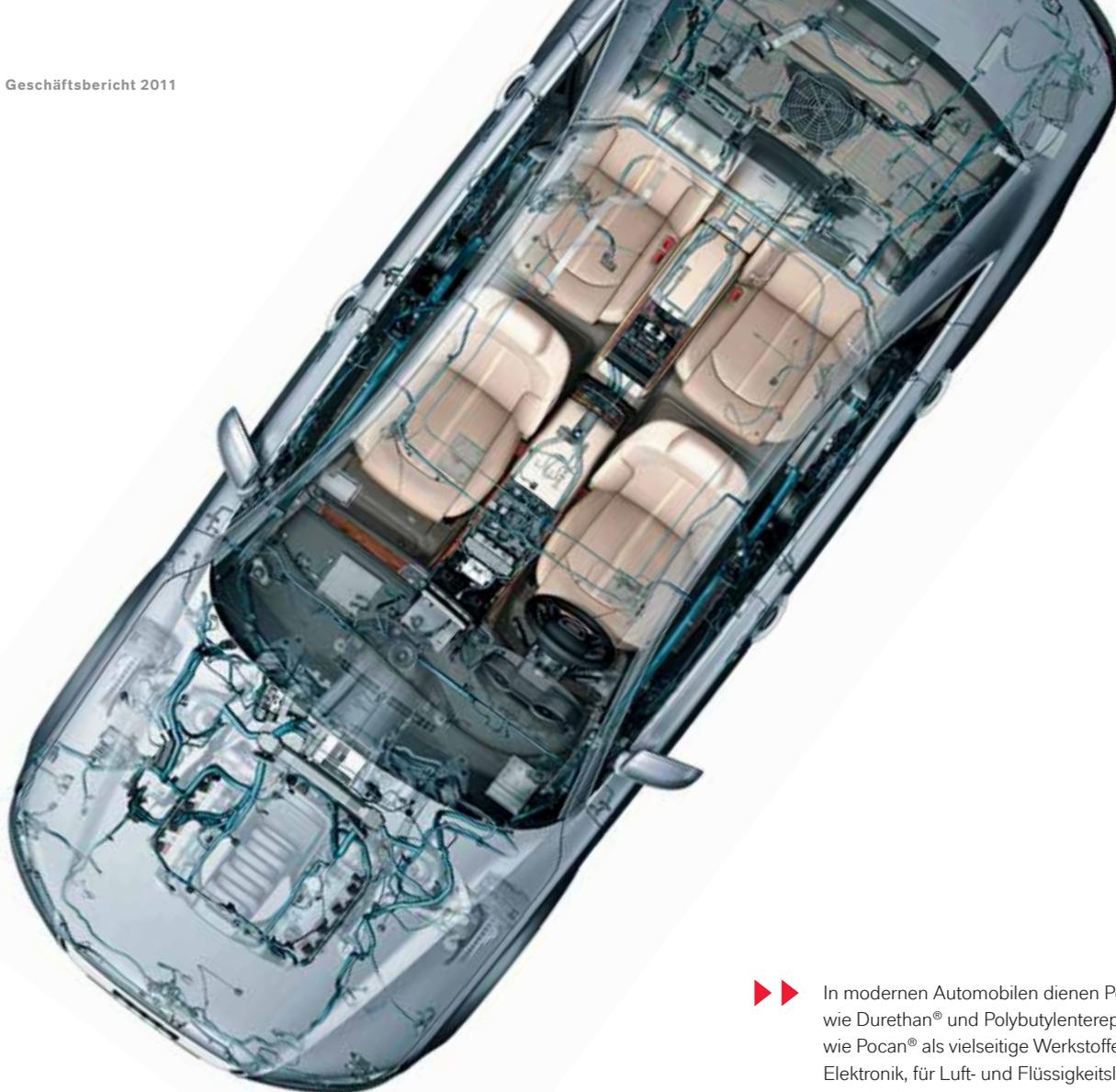
▶▶ In modernen Automobilen dienen Polyamide wie Durethan® und Polybutylenterephthalate wie Pocan® als vielseitige Werkstoffe: für die Elektronik, für Luft- und Flüssigkeitsleitungen oder für Gewicht sparende Karosserieteile.
